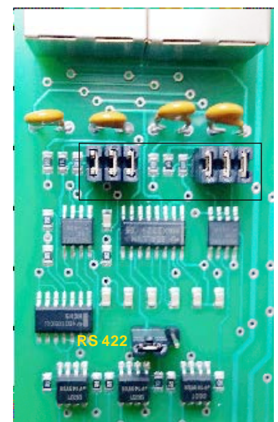
Позиция на джъмперите с пълно терминиране за Сериен интерфейс RS422
