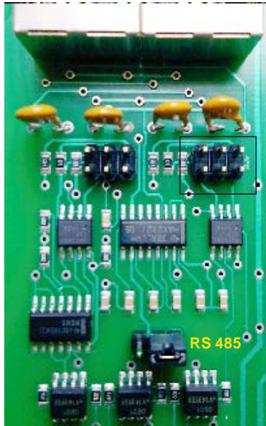
Позиция на джъмперите без терминиране за Сериен интерфейс RS485
